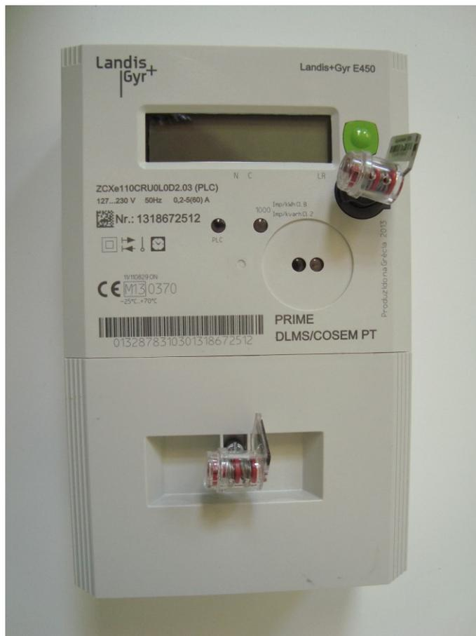
Figura 16- Exemplos de Selagem de tampa com um único parafuso
