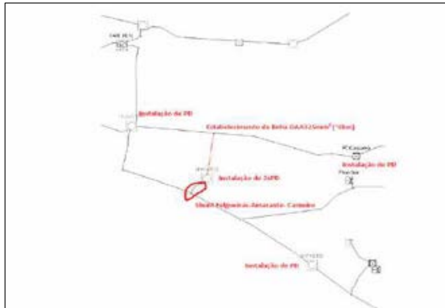
Figura 1. Ligação em T da SE Amarante à LN PC Campanhó – Felgueiras (Rede AT)
