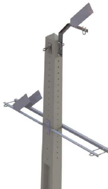
Fig. 2 – Exemplo de Modelo 3D da armação TAN3 (TAN3-60)
