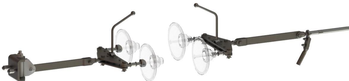
Figura 2– Cadeia dupla de amarração (ascendente/descendente) para linha de 1 condutor de alumínio-aço (160 mm<sup>2</sup>, 235 mm<sup>2</sup> ou 325 mm<sup>2</sup>) por fase.
