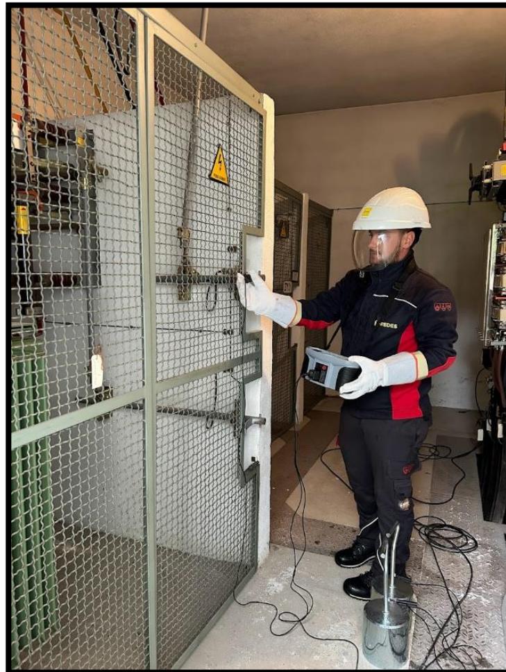
Figura 16 — Exemplo prático de medição da tensão de contacto num PT
