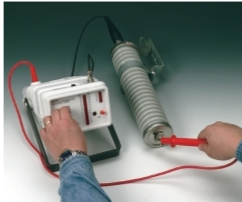
Figura 4-11 – Ensaio de um descarregador de distribuição
