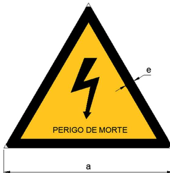
Figura 2 – Sinal de tensão elétrica perigosa.
