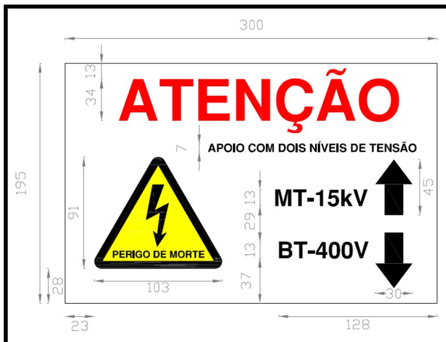
Fig. 3 – Placa identificadora exemplificativa para 15 kV
